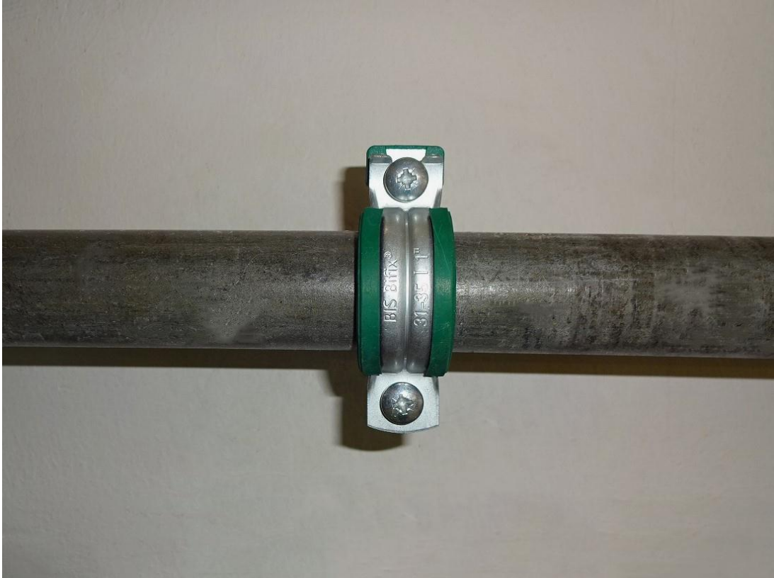
Bild 1: Messung 2: Bifix® G2 mit Einlage, 1" (31 - 35 mm), Anschluss M8/10, mit EPDM-Einlage (20 x 3,70 mm)
