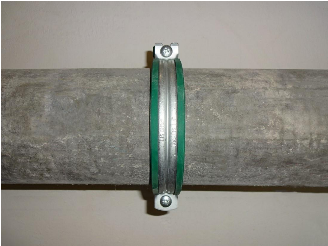
Bild 2: Messung 4: Bifix® G2 mit Einlage, 4" (108 - 115 mm), Anschluss M8/10, mit EPDM-Einlage (23 x 4,20 mm)
